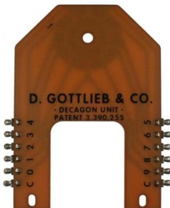
Al circuito stampato presente sulla ruota delle migliaia sono saldati i dieci fili del connettore femmina vuoto vincita punti, ruotando la ruota 1.000 punti collega uno alla volta questi dieci fili al centro strisciante e trasmette l'impulso 24 volt in successione ai dieci settori circuito stampato e perciò ai dieci fili circuito stampato che sono saldati ai dieci buchi vuoto connettore femmina.
